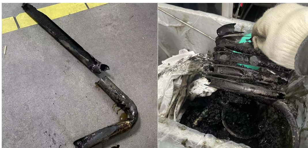
图 4 洗含氯油致罐体腐蚀
