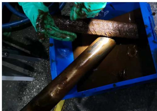
图 3(a) 酸含量高达 16628 ppm 醋酸当量 (b) 被腐蚀的管路
